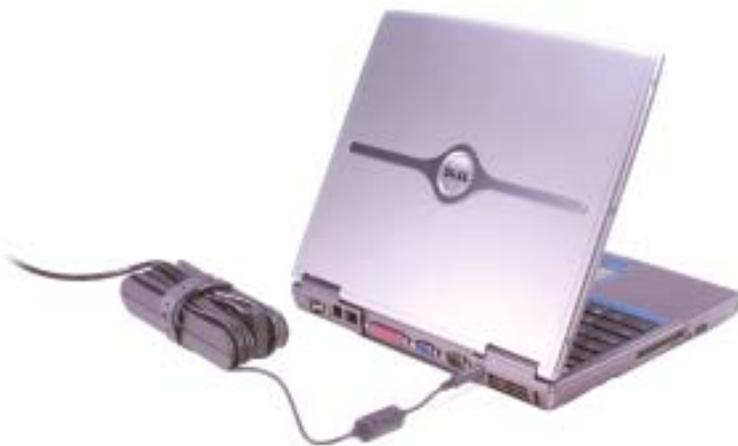
El adaptador de CA convierte la corriente alterna en la corriente continua que necesita el equipo. Puede conectar el adaptador de CA al equipo independientemente de que esté encendido o apagado.
