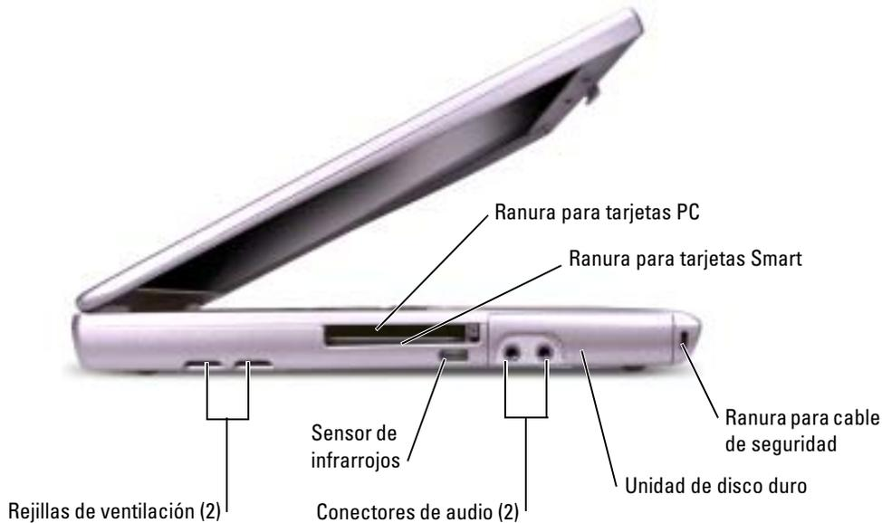
**REJILLAS DE VENTILACIÓN:** El equipo utiliza un ventilador interno para permitir que el aire circule a través de las rejillas y evitar así un sobrecalentamiento.
