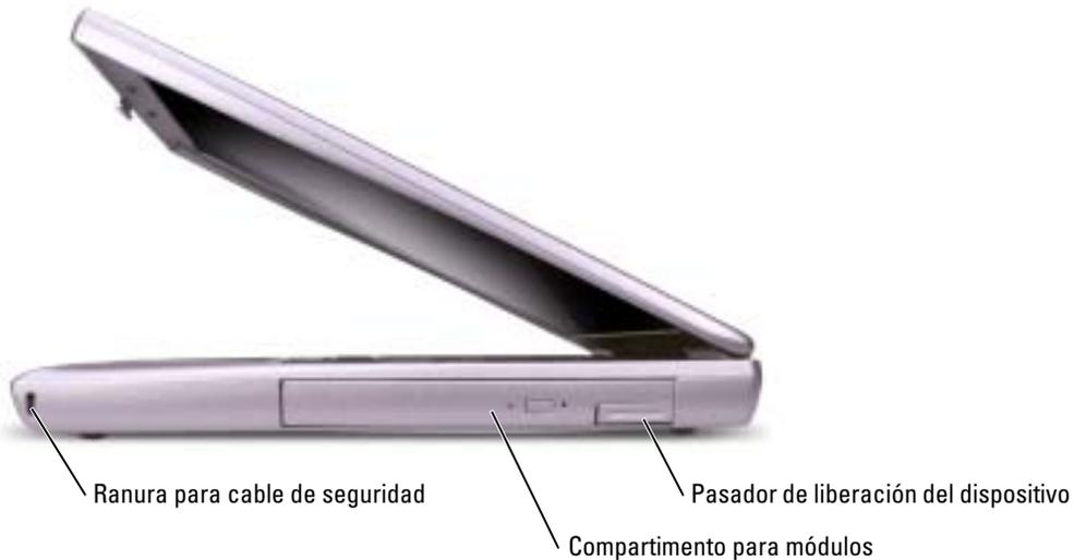
**RANURA PARA CABLE DE SEGURIDAD:** Sirve para conectar al equipo un dispositivo antirrobo disponible en el mercado. Para obtener más información, consulte las instrucciones incluidas con el dispositivo.
